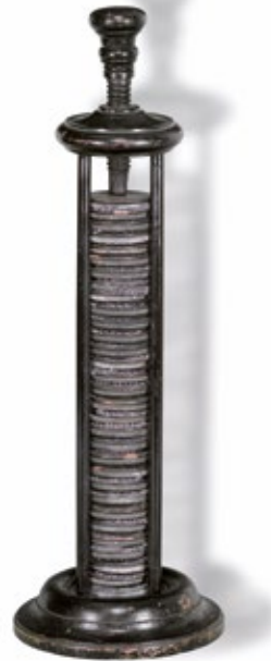
Pile de Volta MHS 373 Cuivre, zinc, verre, bois, Volta, vers 1802
