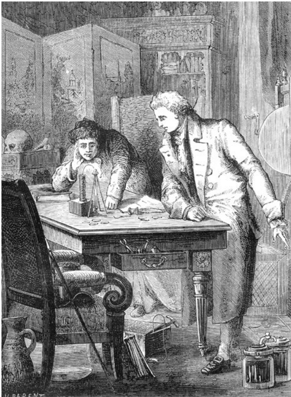
Nicholson and Carlisle decomposing water using a Voltaic Pile Merveilles de la science, Figuier, Paris, 1867. Library of the Musée d'histoire des sciences
