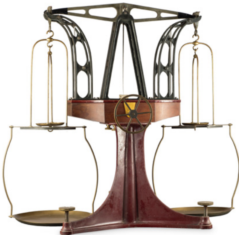
Balance de précision de laboratoire MHS 718 Acier, fonte, laiton, Deleuil, Paris, 19 e siècle
