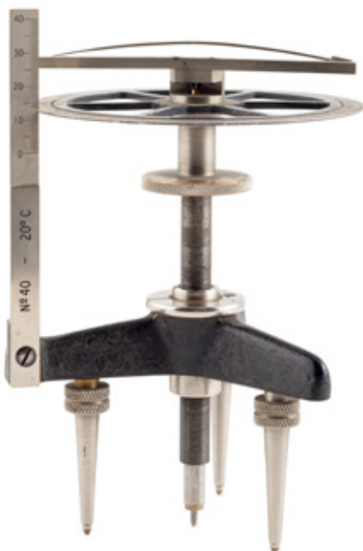
Sphéromètre MHS 2647 Acier, SIP, Genève, 20 e siècle
